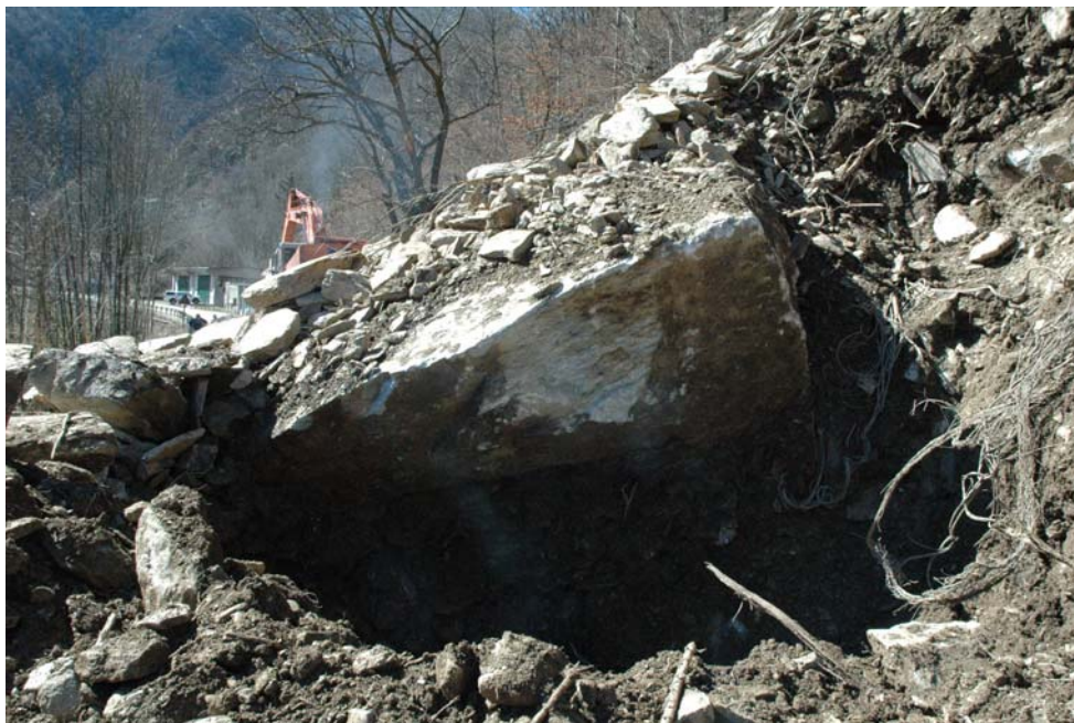
Immagine 03 - Particolare di un grosso blocco immerso all'interno del materiale di accumulo. Foto del 13.04.2011
